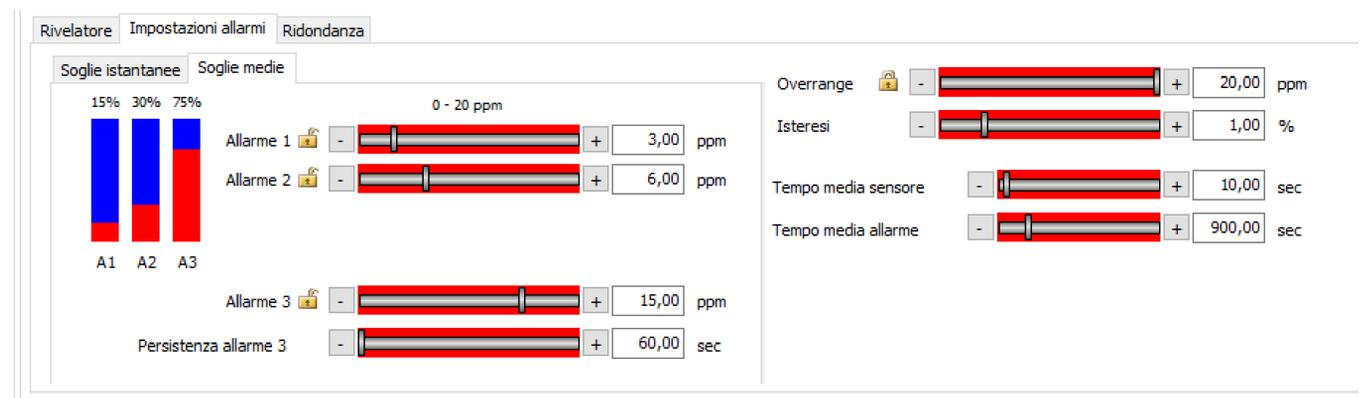
L'impostazione e le modalità operative delle soglie di allarme è diversa a seconda del tipo di centrale (Industrial o Park), del Profile e del Gas Type che si è scelto. Le modalità sono due: Soglie Mediate e Soglie Istantanee.
