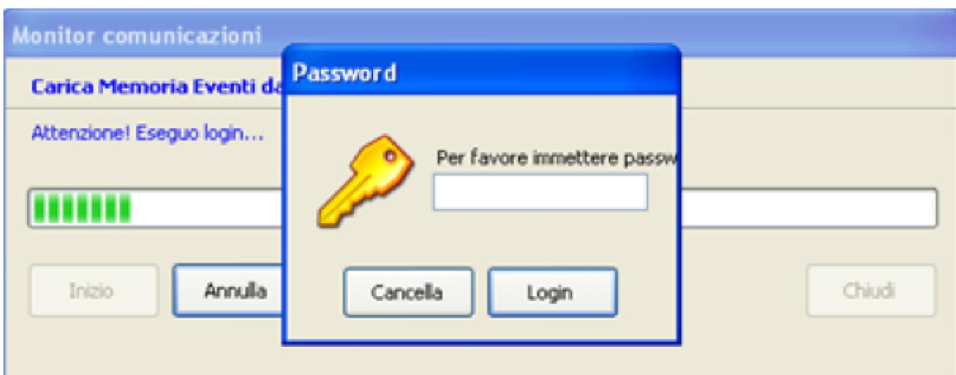
Dopo l’inserimento della password, ha inizio il carico dello storico eventi che può durare fino ad un minuto. Al termine della procedura di carico, gli eventi vengono automaticamente salvati in un file del PC con percorso di default:
