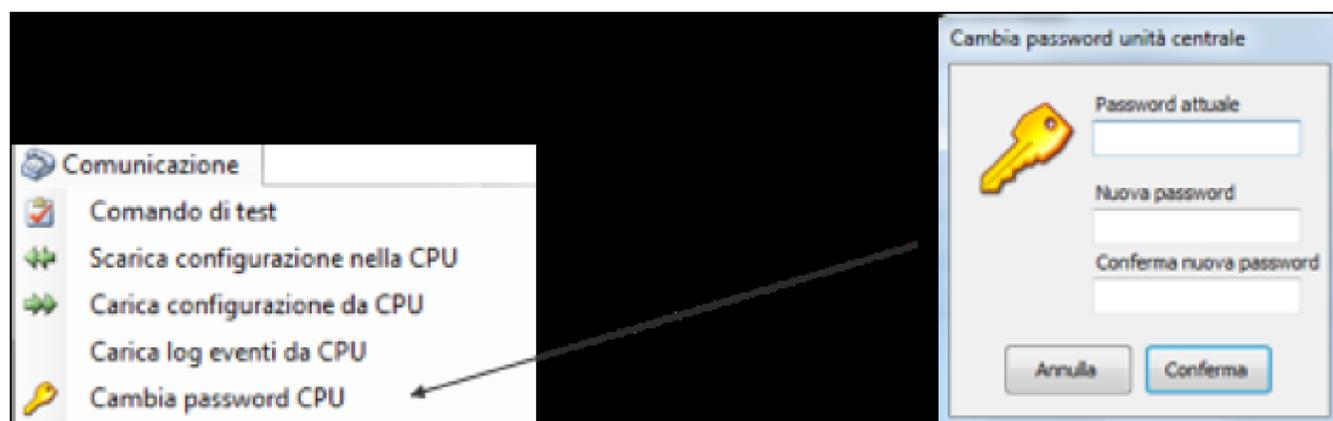
“Scarica configurazione nella Centrale” permette di scaricare il file d’impianto creato nella centrale rivelazione gas.
